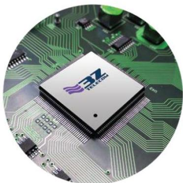
AMP は、小型なモーションプロセッシングデバイスです。リアルタイムで遅滞なく、アンテナの方位/チル/ロール情報を遠隔でレポートすることが可能です。
